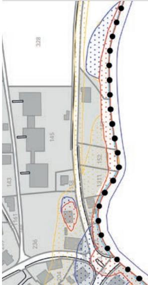
Wassergefahren: Aufgrund zu geringer Abflusskapazitäten im Bereich des Ortseingangs von Zollbrück besteht Überflutungsgefahr. Zudem besteht Verklausungsgefahr durch die niedrige Brücke angrenzend an die Parzelle Nr. 237.
